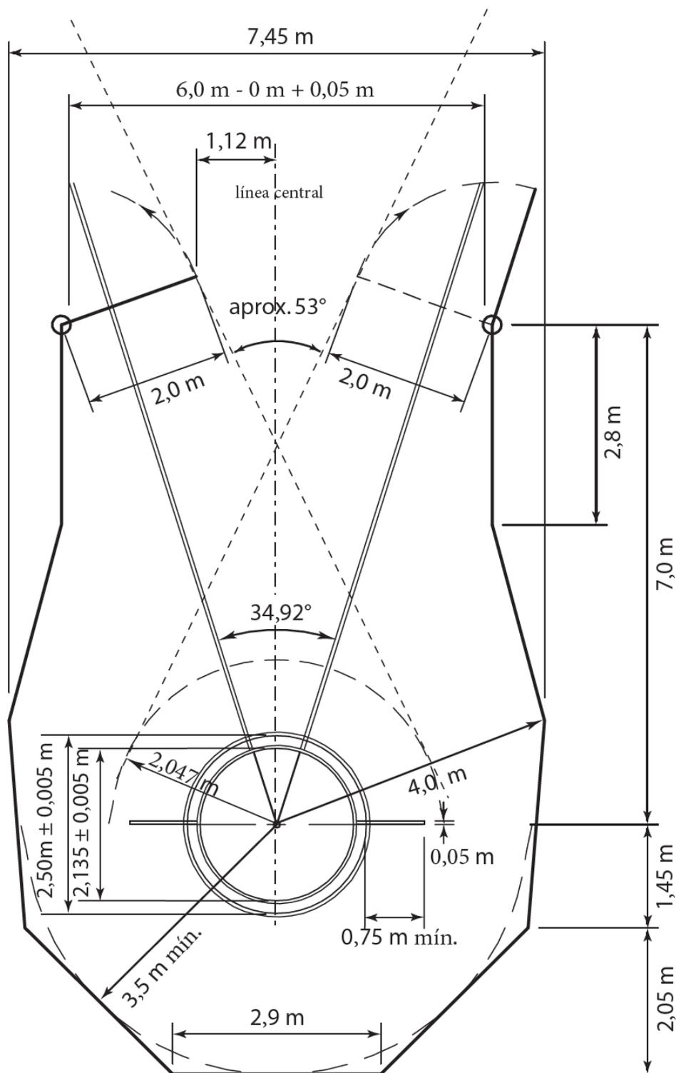
Figura (a) RT37 - Jaula para el Lanzamiento de Martillo y Disco con círculos concéntricos (Configuración para lanzador de Martillo diestro, con dimensiones de la jaula a la red)
