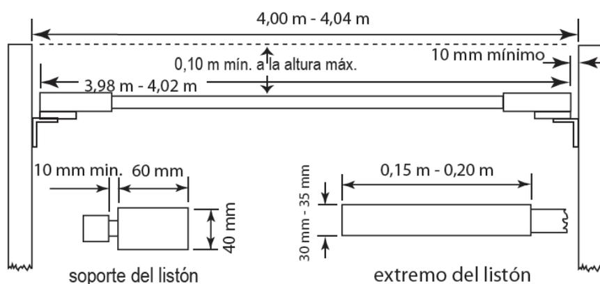
**Figura RT27 - Saltómetros y listón de altura**
