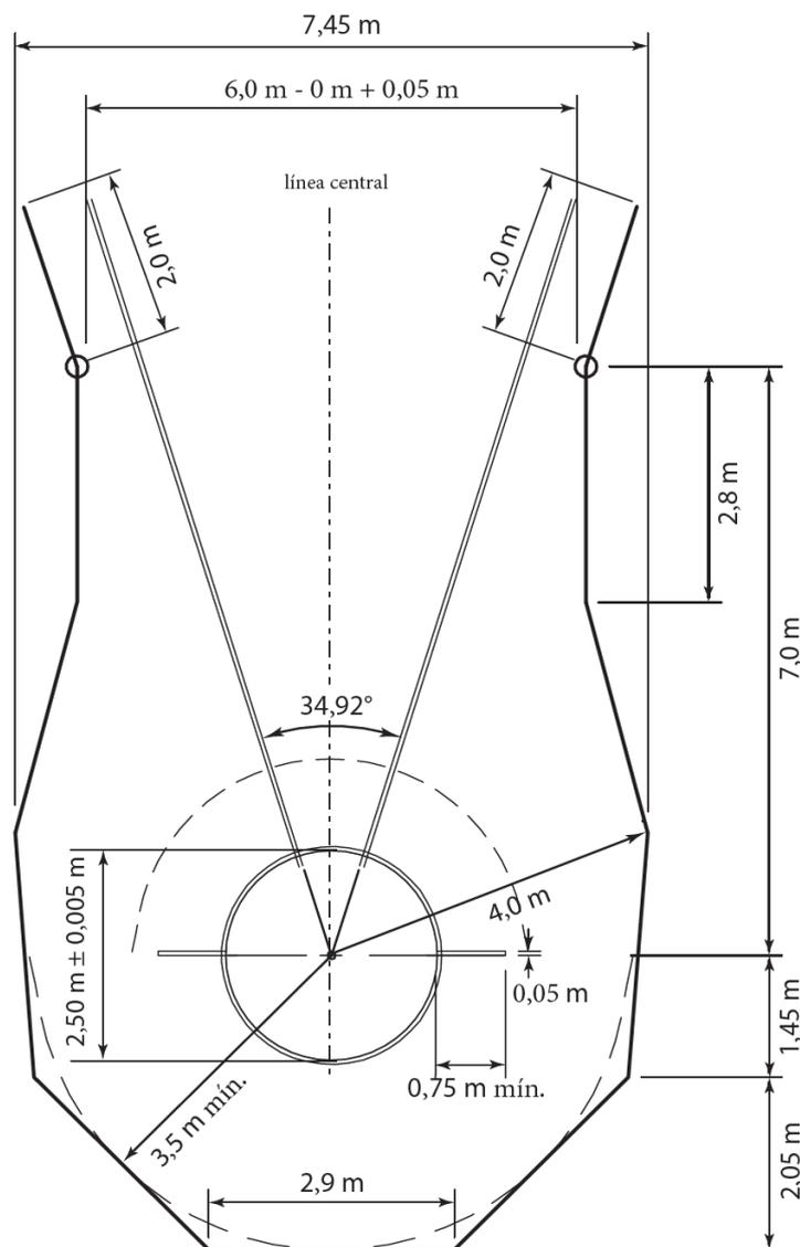
**Figura (b) RT37 - Jaula para Lanzamiento de Martillo y Disco, con círculos concéntricos (Configuración para Lanzamiento de Disco, con dimensiones de la jaula a la red)**
